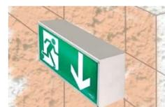
En montage mural encastré béton, le boîtier peut être inséré directement dans le coffrage. Nous recommandons de placer un panneau en bois d'un minimum de 20 mm d'épaisseur (découpé aux dimensions intérieures du boîtier 300x150mm) cloué sur le coffrage. Ceci afin d'empêcher la déformation du boîtier.
